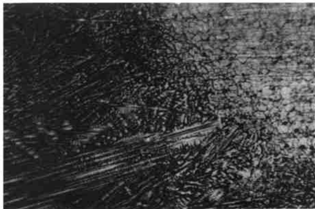
图 4 GH150 对接氩弧焊接头显微组织 (固溶+时效态, 50×, 氯化高铁溶液浸蚀)
